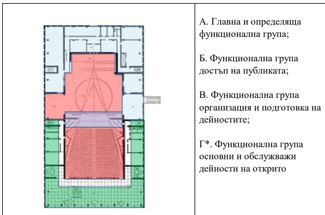
Фиг. 2. Схема на функционално зонироване на пространствата и помещенията в обществена сграда (по проф. д-р арх. Бл. Вълков), графично оформление д-р арх. Р. Райновска
