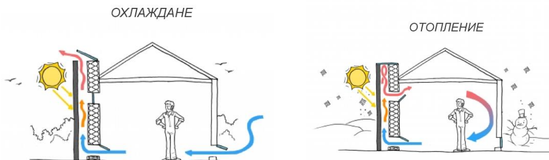
Фиг. 6. Слънчев комин за отопление и охлаждане [3]
