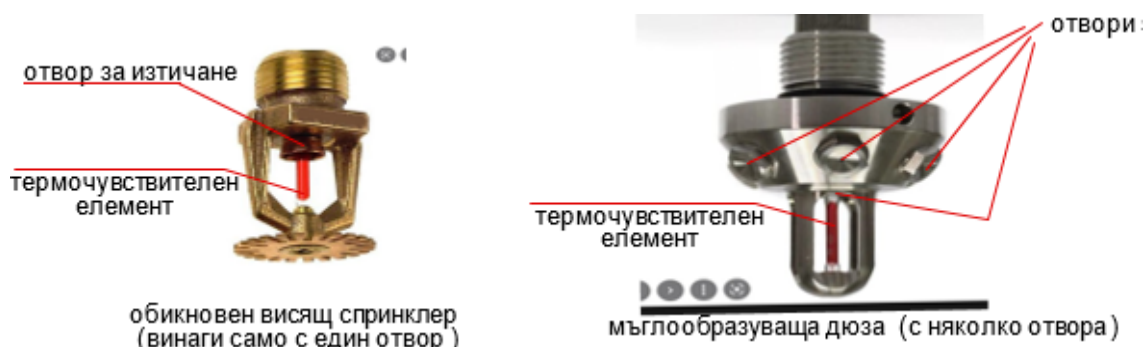
Фиг. 2. Спринклерни глави за мъглообразуващи пожарогасителни системи
