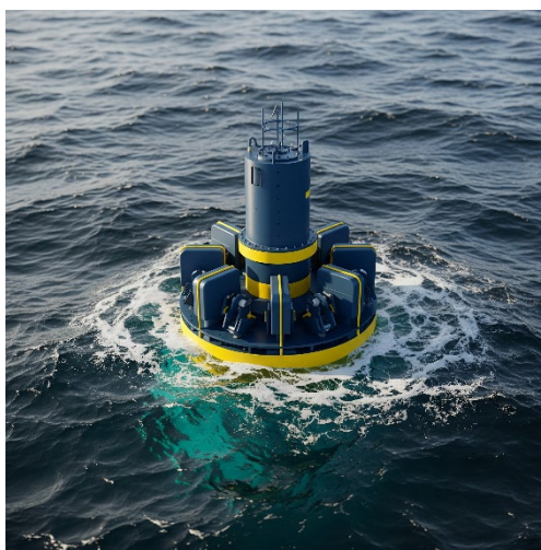
Фиг.1 Преобразувател на вълнова енергия - точков абсорбер[7]
